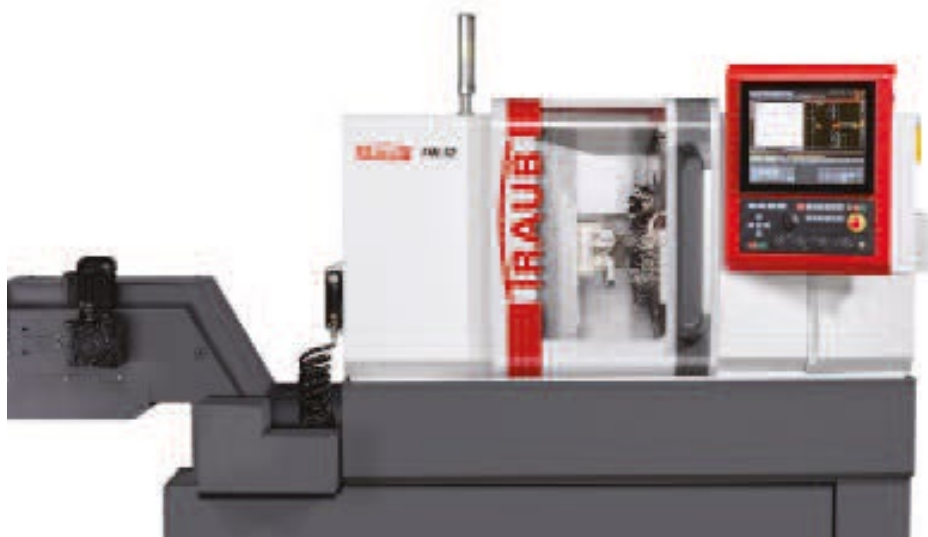
Deutliche Produktivitätssteigerungen bei kleinen Präzisionsdrehteilen mit dem neuen Lang- und Kurzdrehautomat Traub TNL12.
