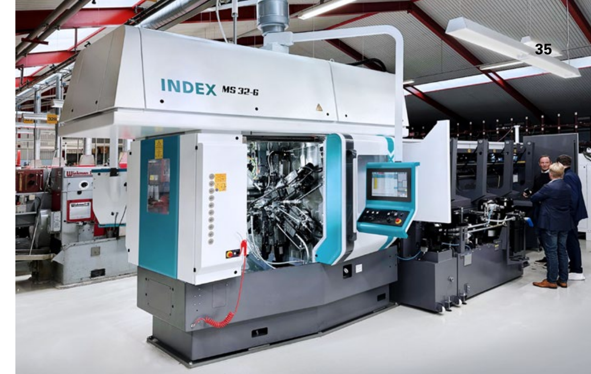
Jüngste REA-Investition: der neue INDEX MS32-6 Mehrspindeldrehautomat, der für hohe Produktivität bei kurzen Zykluszeiten ausgelegt ist. 750.000 Stück dieser Verschraubungen mit Sechskant produziert REA auf dieser Maschine
